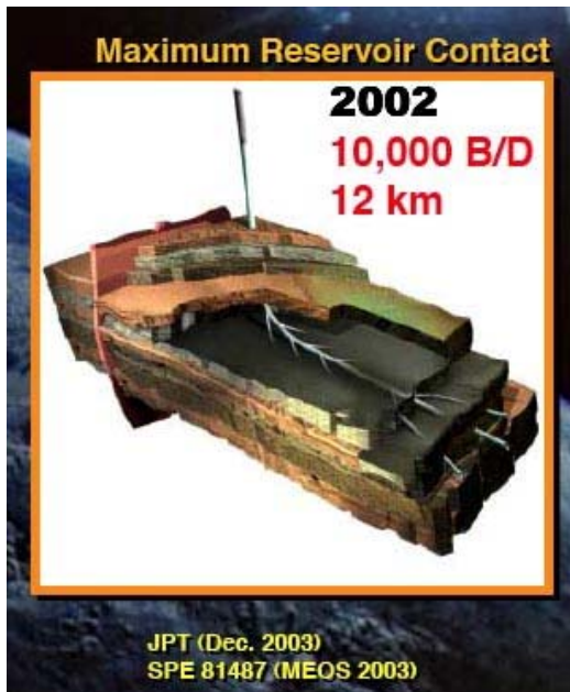
Figure 2 : Schéma de forage horizontal à contact maximum
